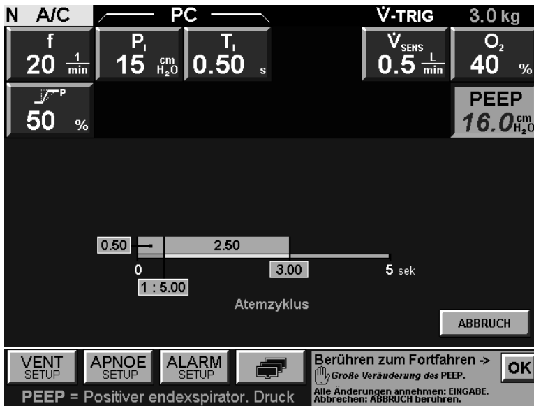
Abb. 3. Bei versehentlichen, großen PEEP-Änderungen wird eine Schutzfunktion aktiv und es erklingt ein akustisches Signal
