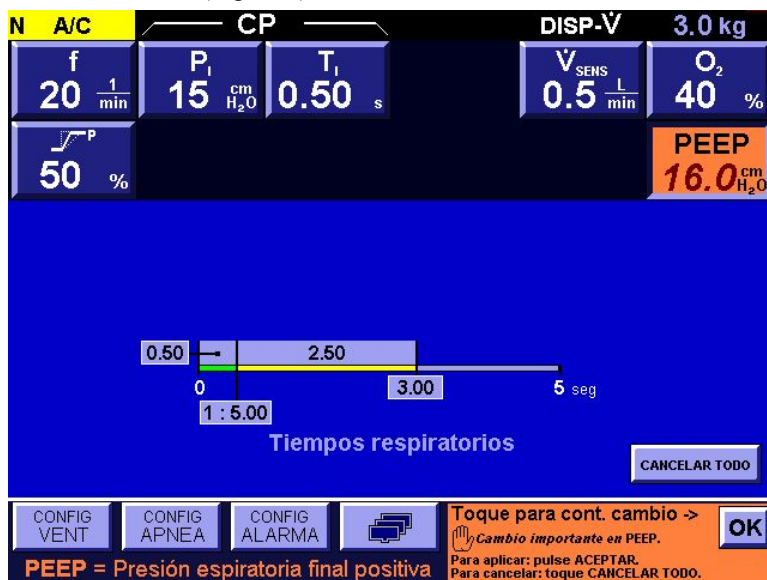
Figura 3. Aparece un aviso, acompañado por un tono sonoro, si se realizan accidentalmente cambios elevados en PEEP
