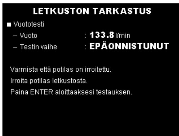
Kuva 1-7. Letkuston tarkastus (valmis, epäonnistunut)
