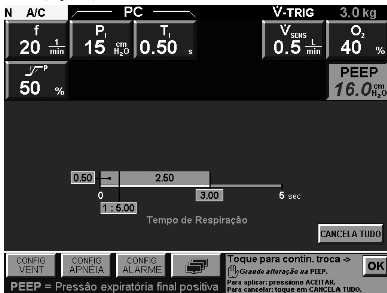
Figura 3. Durante grandes alterações acidentais da PEEP, um limite de segurança flexível será apresentado acompanhado por um sinal sonoro
