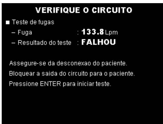
Figura 1-7. Verificar o Circuito (completo, falhou)
