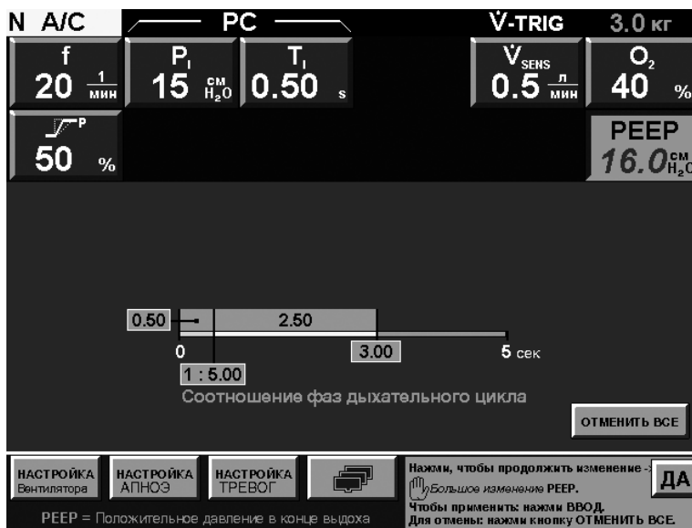
Рис. 3. Мягкая блокировка, сопровождающаяся звуковым сигналом, появляется при непреднамеренных значительных изменениях PEEP
