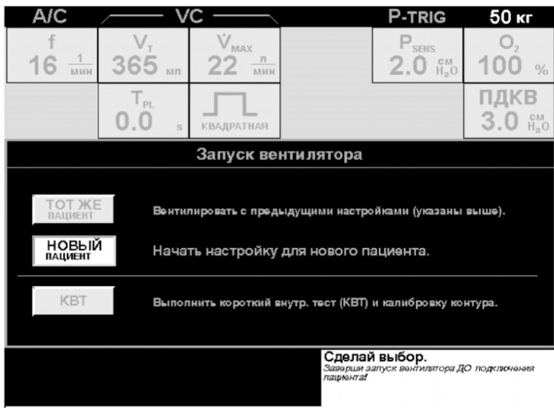
Рис. 1. Экран запуска вентилятора
