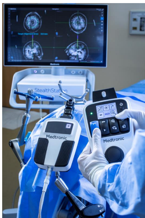
「ステルスAutoguide」(承認番号: 30200BZX00298000) 手前左: ターゲティングユニット 手前右: コントロールユニット
