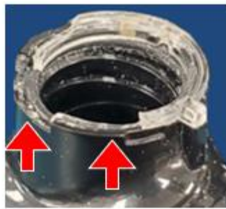
リテーナーの損傷・欠け (ひび割れ、ゆるみ含む) 使用を中止してください
