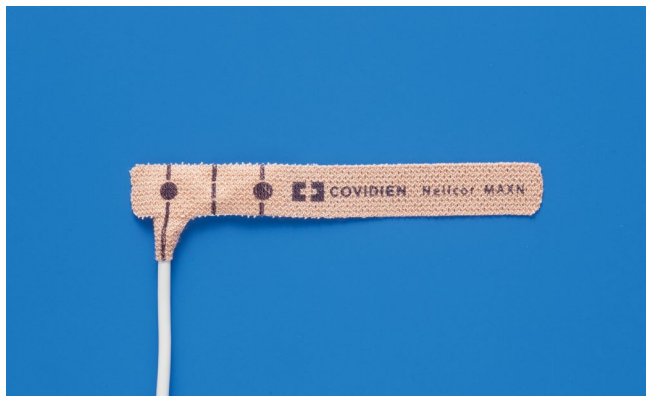
図2 N-25 受光部と発光部の距離：25mm
