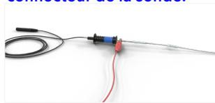
Sonde IS-1, pince **anodique rouge (+)** connectée à l'anneau anodique de la sonde pour une connexion bipolaire.
