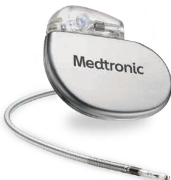
Παραδοσιακός βηματοδότης και ηλεκτρόδιο
