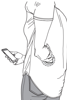
Afbeelding 4. Houd de communicator tijdens het instellen boven uw neurostimulator.
